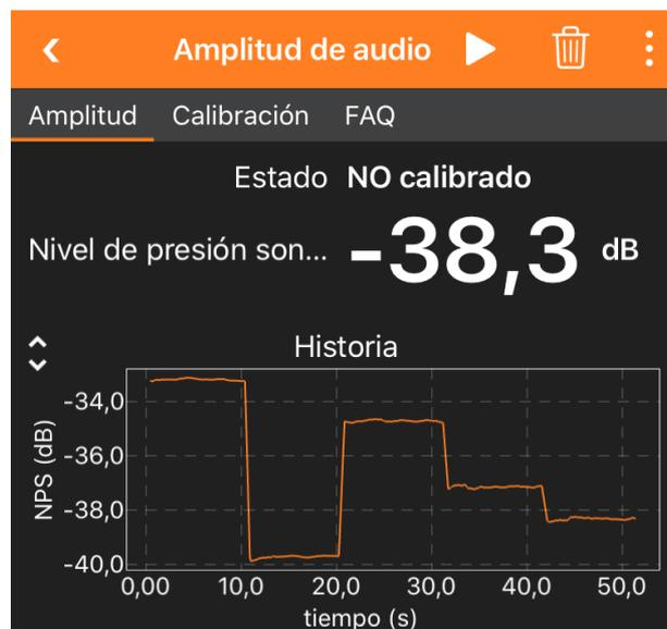
Figura 46. Captura de pantalla de la utilidad amplitud de audio una vez realizada la toma de datos para las distintas condiciones de aislamiento acústico
