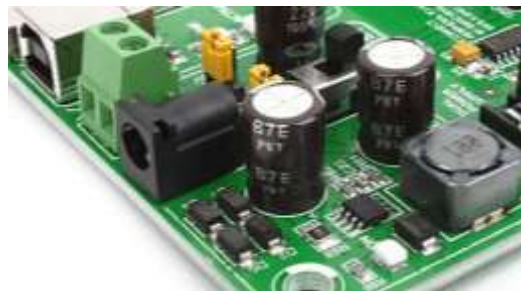
Figura 15. Módulo de alimentación de la placa EasyPIC PRO v7.
