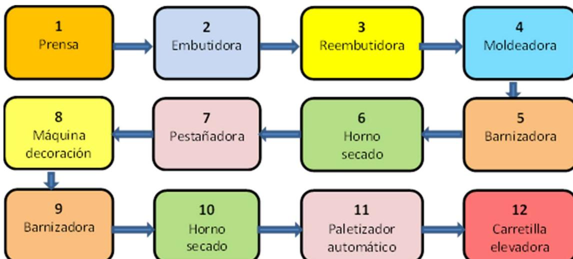
Fig. 15. Diagrama del proceso productivo de los envases de dos piezas DRD.
