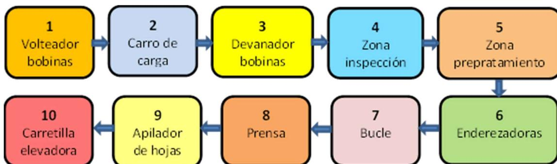
Fig. 7. Diagrama del proceso productivo de almacén y corte de bobinas.
