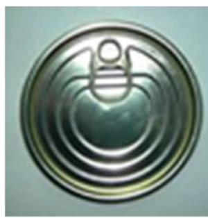
Fig. 18. Ejemplo las tapas que se producen.
