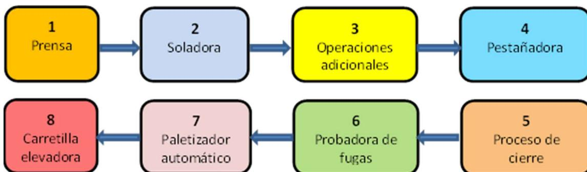
Fig. 10. Diagrama del proceso productivo de la formación de envases de tres piezas.
