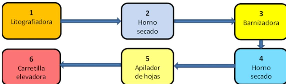
Fig. 9. Diagrama del proceso productivo del barnizado de envases de tres piezas.
