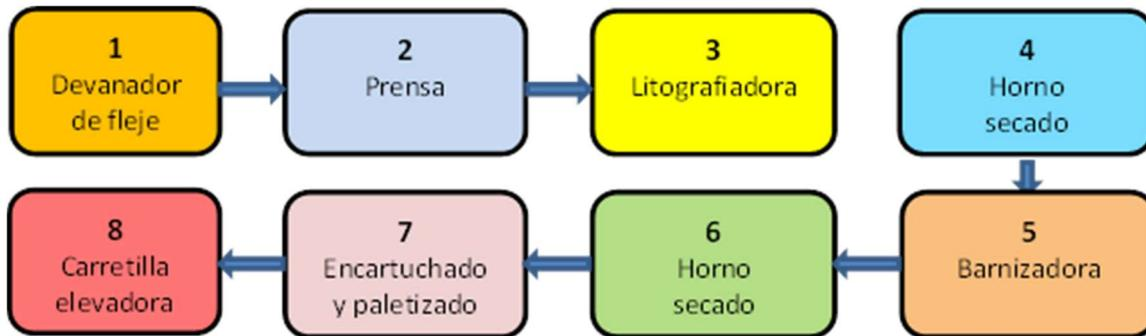
Fig. 20. Diagrama del proceso productivo de tapas especiales.
