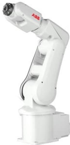
Figura 1.3: Robot IRB 120 de la marca ABB.
