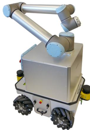
Figura 2.2: Ejemplo de robot montado sobre un vehículo de guiado automático.
