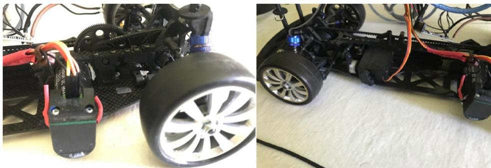
Ilustración 13: Motor con encoder y mecanismo de transmisión a las ruedas
