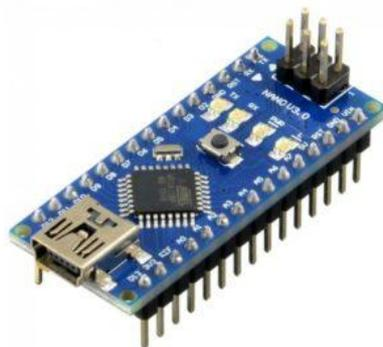
Ilustración 4: Arduino nano
