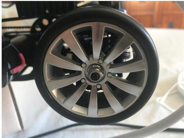
**Ilustración 32:** Marca realizada en la rueda para calibrar el *encoder*
