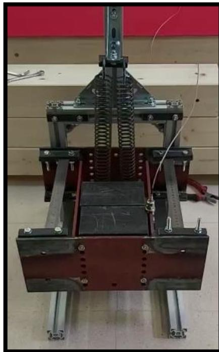
Figura 105. TMD con muelles y cargado (Prototipo)
