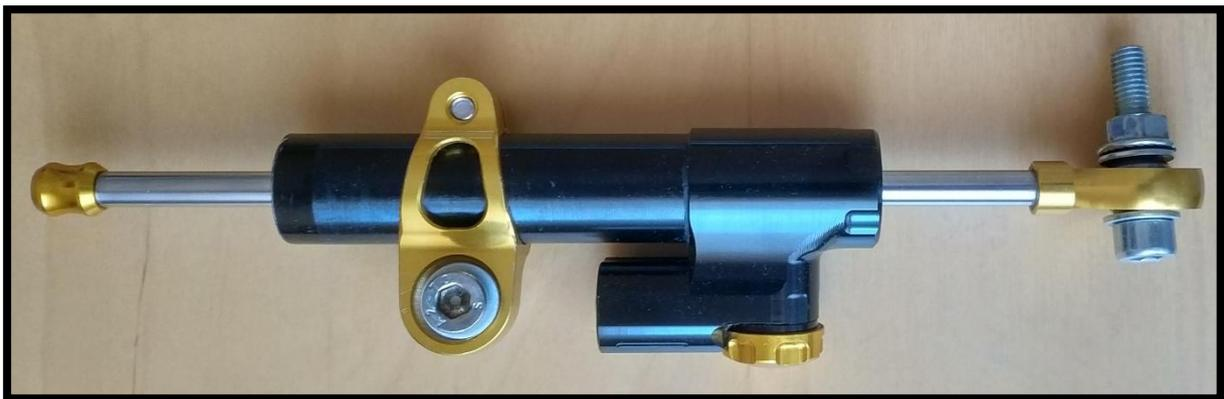
*Figura 100. Amortiguador (Prototipo)*
