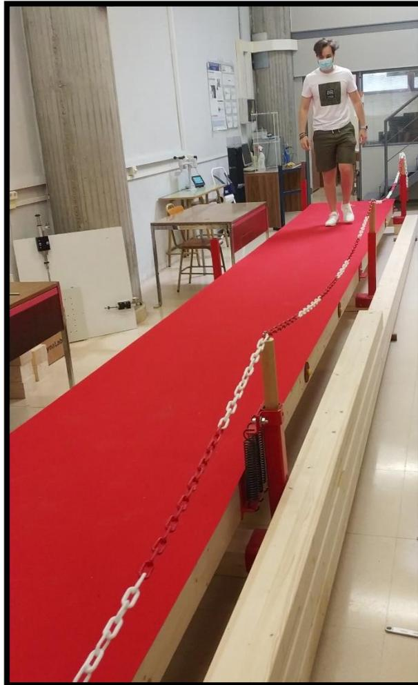
*Figura 103. Puente de madera colgante (Estructura de ensayo)*
