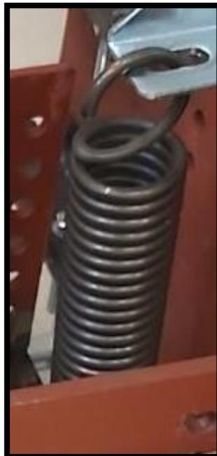
*Figura 99. Muelle situado en el prototipo TMD*
