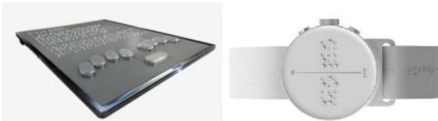
Figura 11. Tablet y reloj de pulsera en Braille
