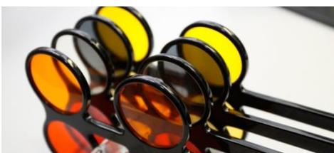
Figura 4. Filtros de corte de absorción selectivo.<sup>5</sup>
