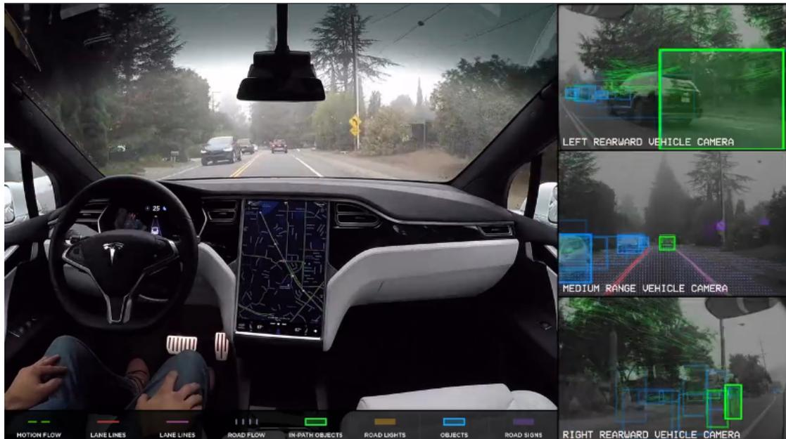
Figura 13: Imagen de un coche autónomo de Tesla obtenida de un vídeo donde se ve que el conductor no manipula en ningún momento el vehículo y se ven algunas de las imágenes procesadas obtenidas mediante las cámaras del vehículo a la derecha de la imagen [6]
