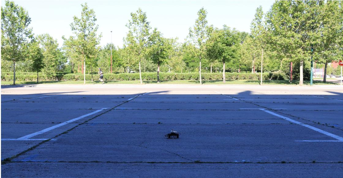
Figura 36: Imagen del robot diseñado entre unas líneas que simulan las líneas de tolerancia a 3 metros por cada lado calculadas por el programa
