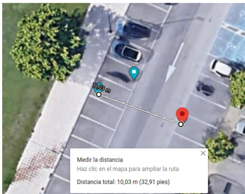
Figura 27: Captura de pantalla de la representación en google maps de coordenadas calculadas en la anterior figura. El punto rojo es la posición del ordenador y por tanto, la correcta. El error es de 10,03 metros. El segundo punto azul es la posición registrada por el primer sensor.
