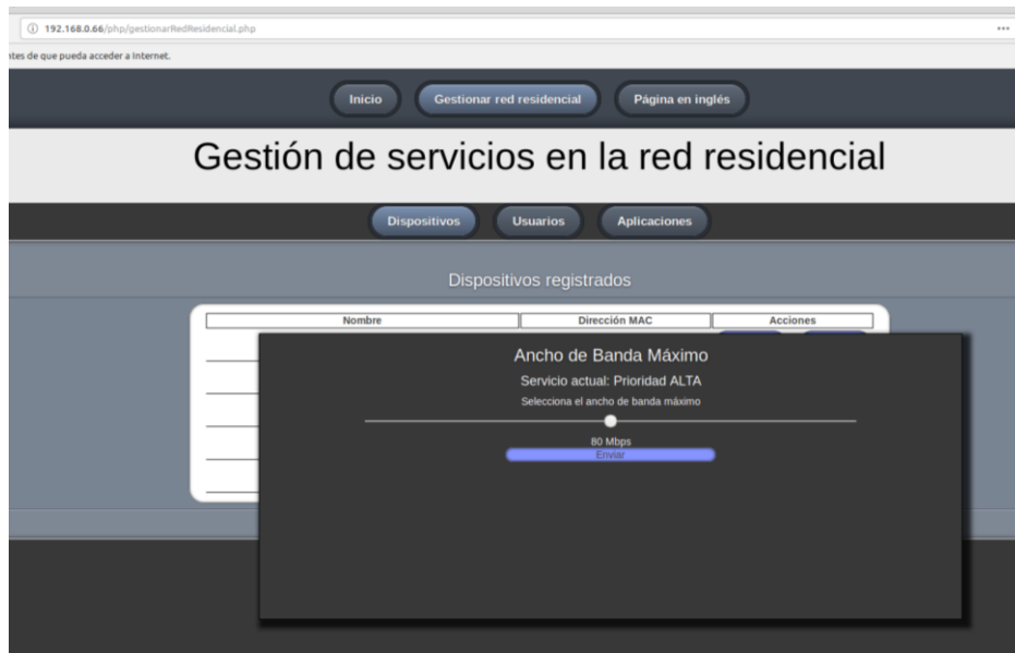
Figura 51: Restricción de un ancho de banda para un dispositivo
