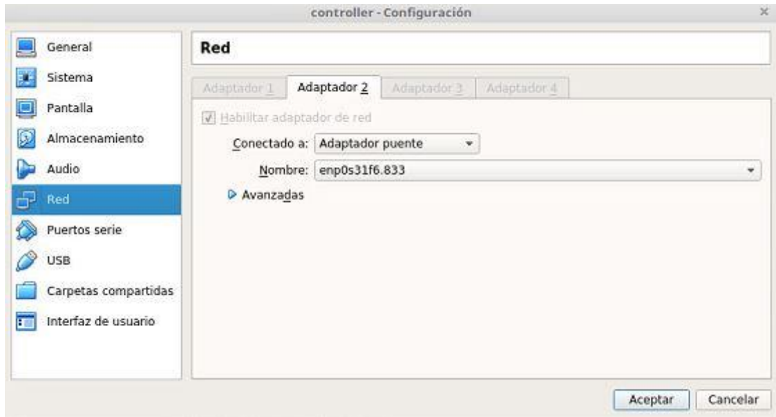
Figura 18: Configuración final de red de la máquina virtual del controlador
