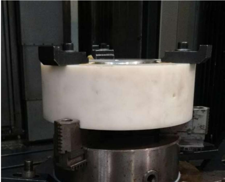
*Ilustración 51 Fabricación de la estructura metálica, segunda etapa en fresadora (Cortesía del laboratorio L2EP/ENSAM).*
