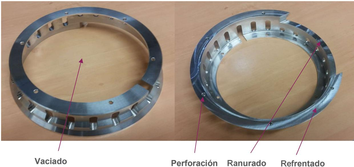
*Ilustración 53 Estructura metálicas terminada (Cortesía del laboratorio L2EP/ENSAM).*
