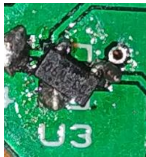
Figura 56: RT9058-33GV soldado a la PCB
