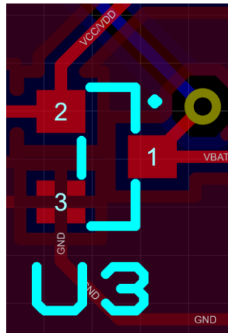
Figura 55: Huella de RT9058-33GV conexionada erróneamente
