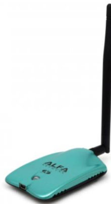
Figura 4: Interfaz de red inalámbrica usada para el despliegue del punto de acceso malicioso. Es capaz de realizar la funcionalidad de punto de acceso.
