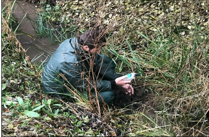
Figura 5. Toma de datos con el dispositivo PCE-PHD1, en el río Anguijón. Fuente: Carlos Escudero Ortega.
