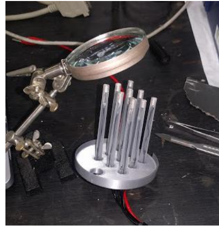
Figura 1: Construcción del soporte de la lengua potenciométrica.
