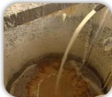
**Reacción de saponificación** en medio acuoso y con burbujeo de vapor, para mantener la mezcla fluida y facilitar la reacción
