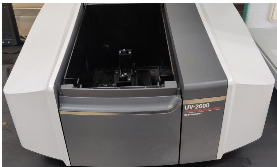
Figura 12: Espectrofotómetro de doble haz UV-2600 (Shimadzu)
