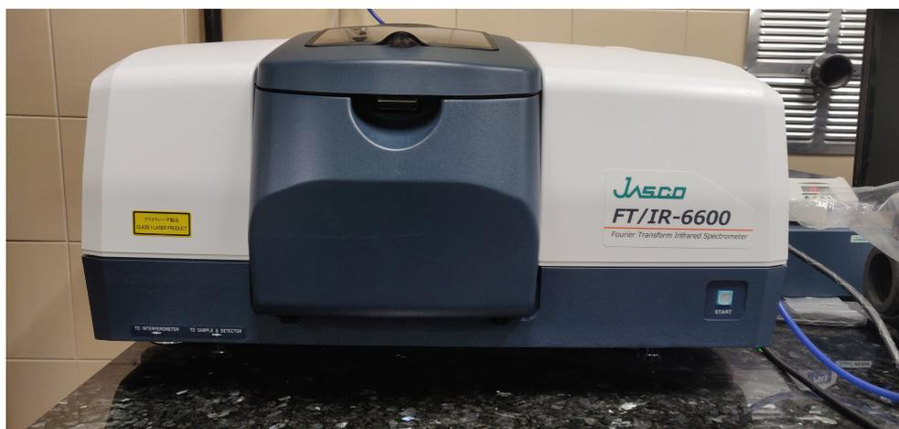
Figura 13: Equipo de espectroscopía por transmisión de infrarrojo por transformada de Fourier (FTIR) FT/IR-6600 (Jasco).
