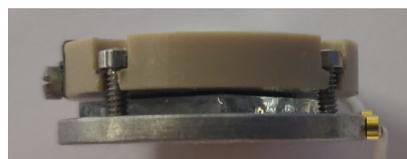
Figura 2: Vista lateral de la celda EC-Cell montada correctamente. Nótese que no se observa el O-Ring porque está dentro del raíl de la EC-Cup
