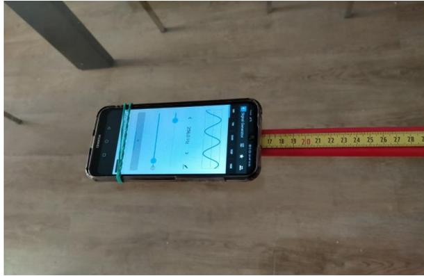
Imagen 3. Colocación del smartphone en la varilla con la cinta métrica mediante una goma elástica
