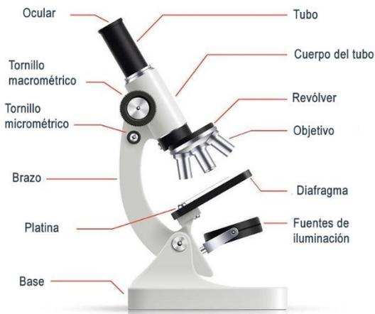
**Figura 10. Microscopio óptico.**
