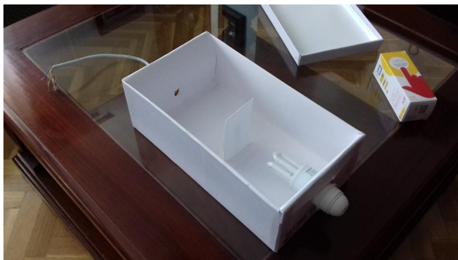
Imagen 4.4: Montaje completo con bombilla. El orificio para el acceso a la placa prototipo tiene el tamaño mínimo necesario para permitir colocar los sensores.
