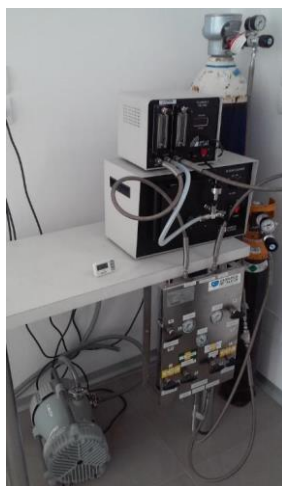
Figura 14: Equipo Harrick Plasma Cleaner PDC-002 sobre la mesa, a la derecha las bombonas de oxígeno y argón y a la izquierda el compresor.
