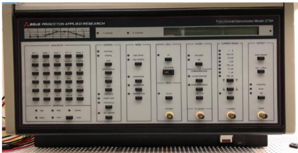
Figura 4. Potenciostato empleado en el trabajo, modelo 273-A.
