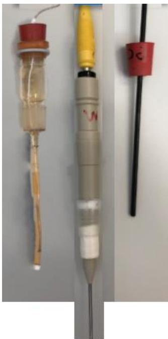
Figura 4. De izquierda a derecha, electrodo basado en el par (Ag(I)/Ag), electrodo de W y electrodo de carbono vitrificado (GC).
