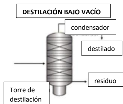
Imagen 5: Esquema de un equipo de destilación bajo vacío. (Liguori et al, 2018)
