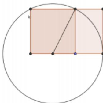
Figura 3.3.16. Construcción de un rectángulo áureo.
