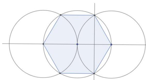
Figura 3.3.11. Construcción del hexágono regular con regla y compás.
