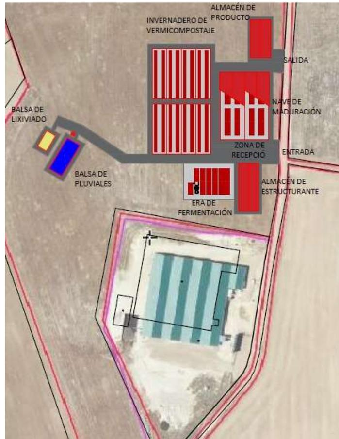
Imagen 14: Disposición general de la planta de compostaje
