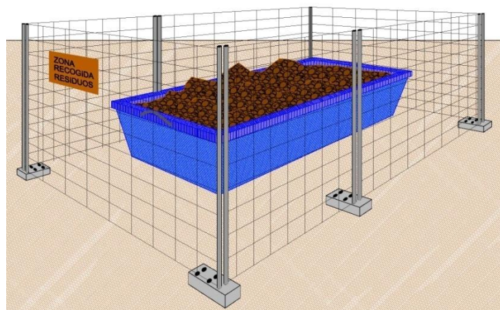
Ilustración 1: Contenedor depósito residuos en obra, con vallado perimetral
