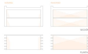
Los pórticos que conforman la estructura del edificio controlan el soleamiento. Al realizar un estudio del soleamiento en invierno y el verano, observamos como los pórticos actúan como protección frente al mismo sin evitar las visuales del exterior.
