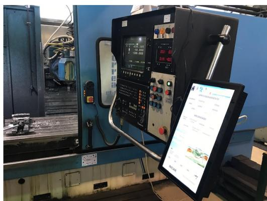
Figura A.1: Equipo con pantalla táctil con el sistema de control instalado
