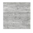
Muros de contención en planta sótano, de 40 cm. Acabado del material visto con textura de tabla de madera. Se va a aplicar en patios o muros exteriores. La altura de éstos alcanzará los 4-4,5m.
