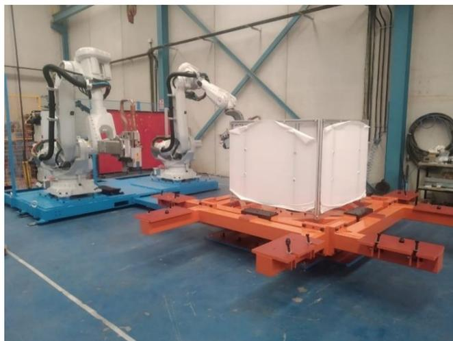
Ilustración 28 – Foto de la mesa de giro y los robots en las instalaciones de Boscotecnico en el montaje.
