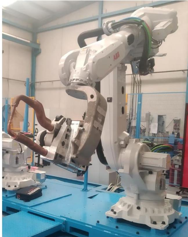
*Ilustración 55 – Foto robot ABB IRB 6700 con pinza de soldadura ARO 3G.*
