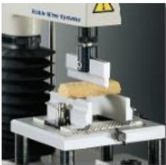
**Figura 1.** Analizador de textura TA-XT2 (Stable Microsystems, Surrey, Reino Unido).
