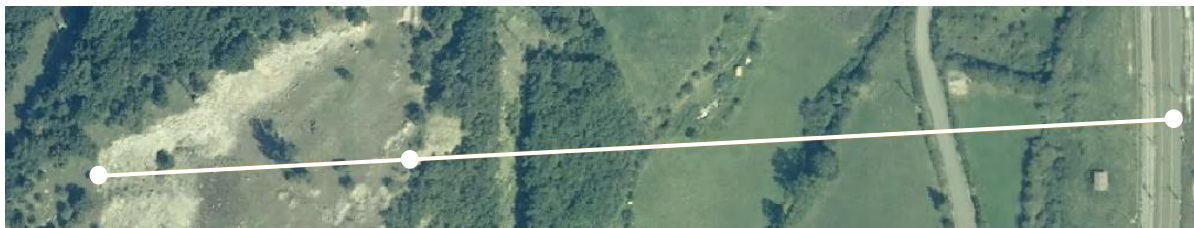
Figura 3. Mediciones realizadas sobre plano con cada uno de los puntos. Primer punto en la zona más alta de la cantera, segundo en el borde de la explanada y tercero en el punto objeto de estudio.
