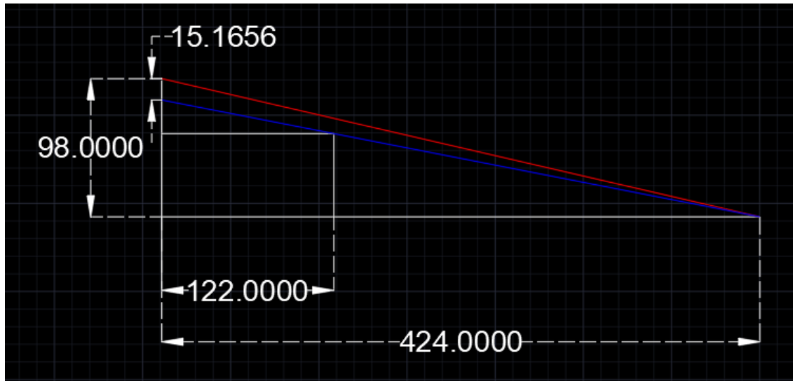
Figura 37. Modelo en dos dimensiones en el que se muestra la porción de la cantera visible actualmente
