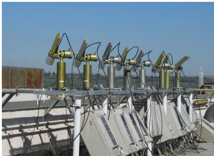
Figura 1.2: Fotómetro solar, GOA-UVA.
