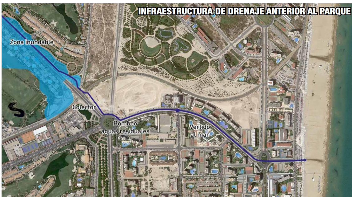
Ilustración 31 Infraestructura de drenaje anterior al parque La Marjal Fuente: Ayuntamiento de Alicante 61 .
