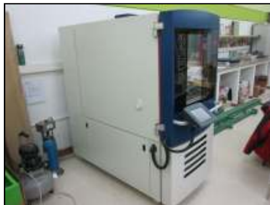
Fig. 20 Cámara de ensayos térmicos y climáticos
