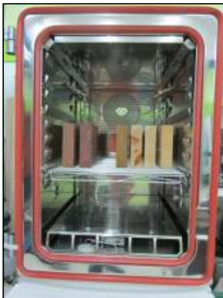
Fig. 23. Interior de la cámara climática
