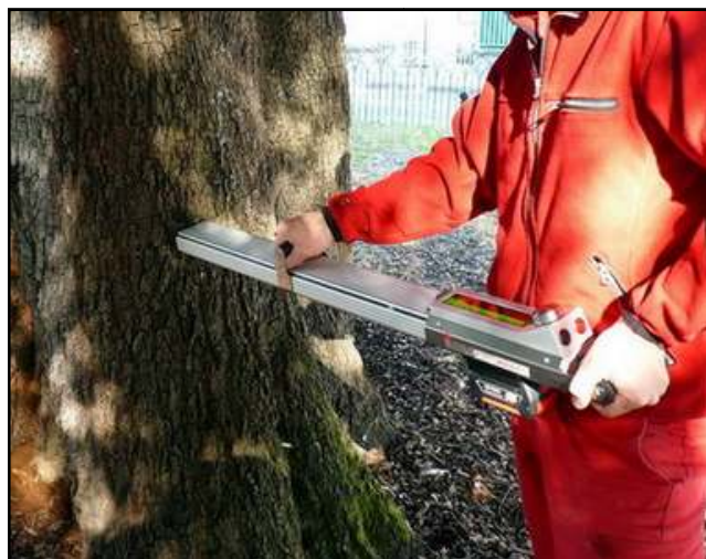
Fig. 9. Aplicación en arbolado del resistógrafo.
