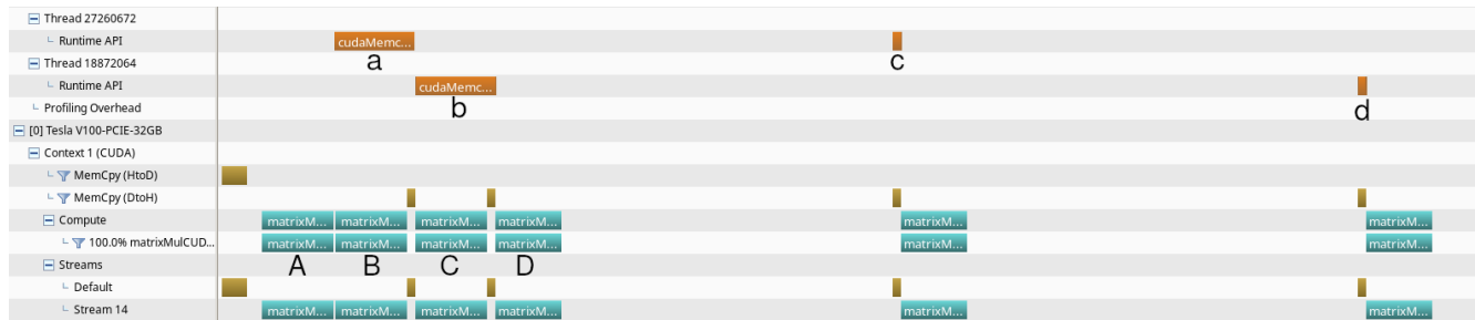
Figura 5.2: Resultados en el profiler para la nueva versión. Las letras mayúsculas indican los kernels, las minúsculas indican las transferencias de los resultados de cada kernel.
