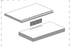
DETALLE EN AXONOMETRÍA: HERRAJE DE UNIÓN PANELES DE CLT (FORJADO DE LA TORRE)
