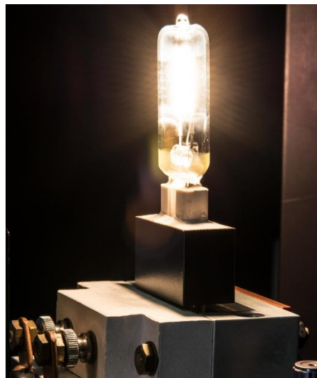
Figura 8. Lámpara tipo FEL de 1000 W.
