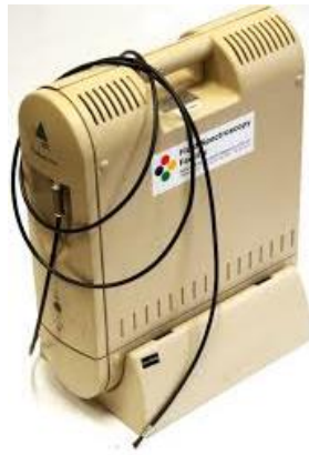
Figura 7. Espectrorradiómetro FieldSpec® Pro.
