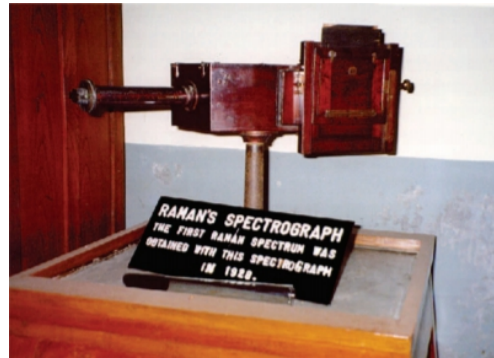
Figura 3.2: Primer espectrómetro Raman de la historia. Datado en 1928.
