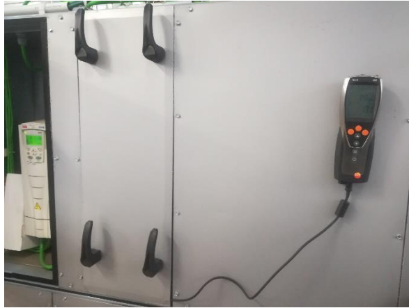
Figura 5.11.- Fotografía del anemómetro en el momento de la toma de medidas.
