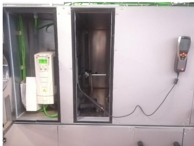
Figura 5.10.- Fotografía del anemómetro y la sonda con la compuerta abierta.
