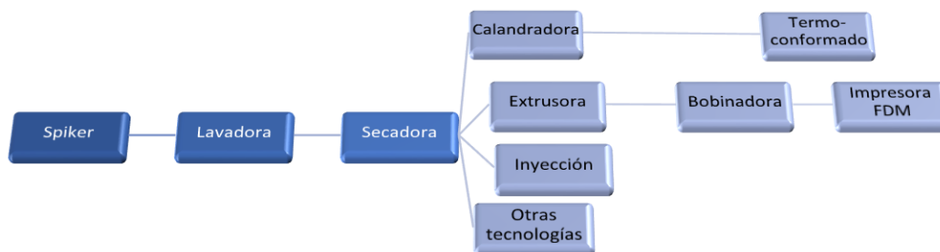
Figura 2: Diagrama de flujo para el reciclado de plásticos. Elaboración propia.
