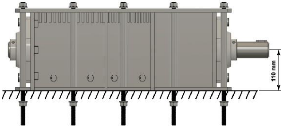
Figura 139: Altura de la entrada de Spiker respecto a la bancada. Elaboración propia.
