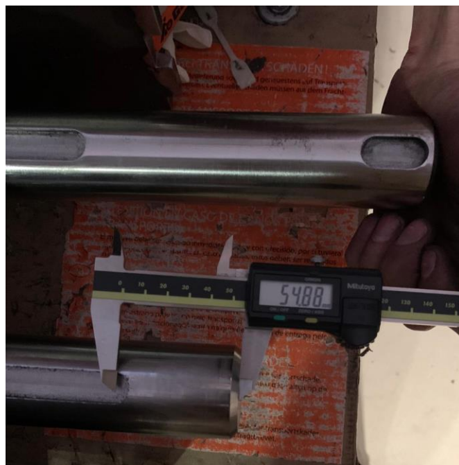
Figura 154: Error de mecanizado del eje. Elaboración propia.
