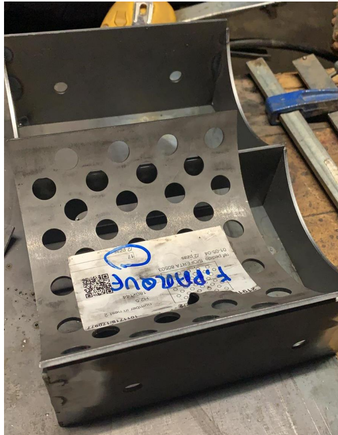
Figura 156: Rejilla plegada por el eje erróneo. Elaboración propia.
