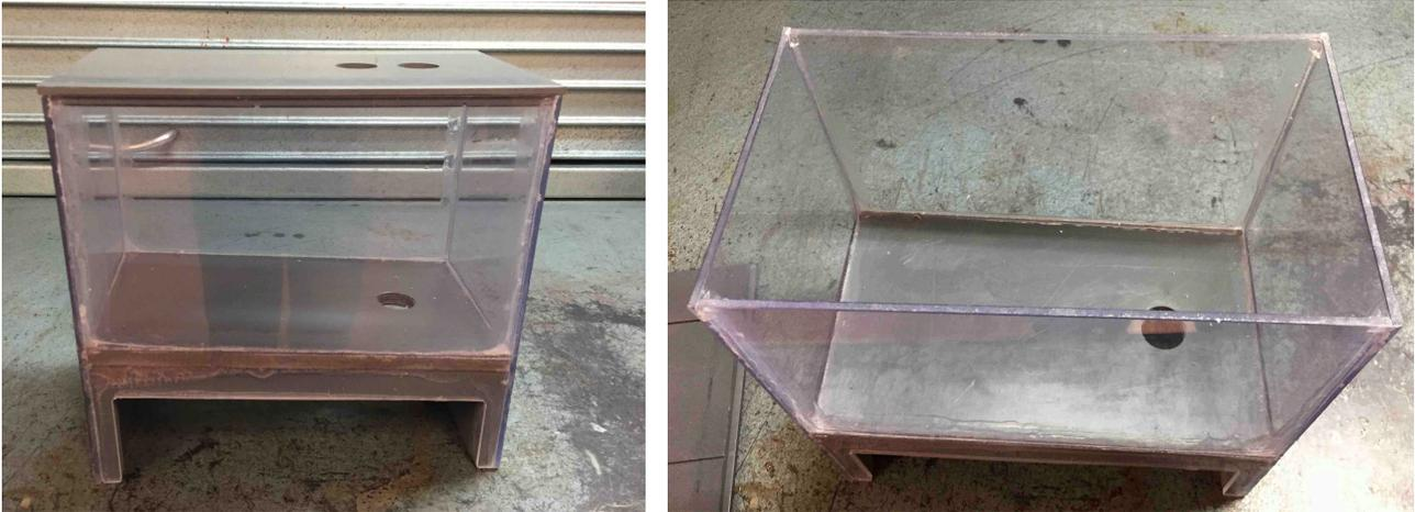
**Figura 5.1:** Modelo del depósito de descarga utilizado en la instalación.
