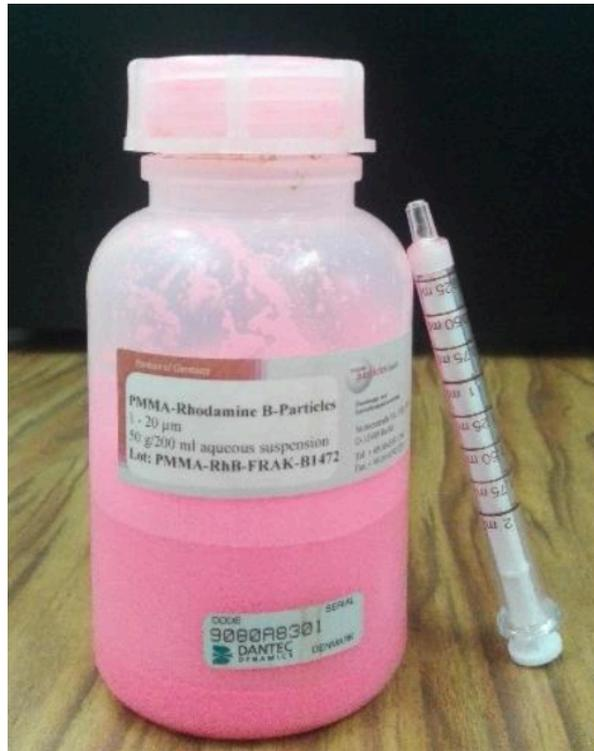
**Figura 3.5:** Partículas trazadoras utilizadas.
