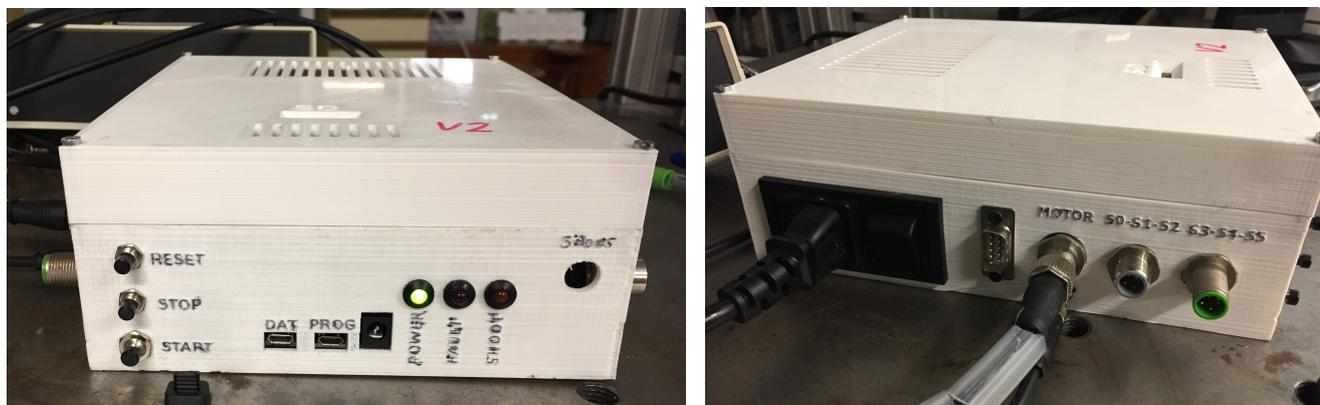
**Figura 4.27:** Caja electrónica que funciona como sincronizador.
