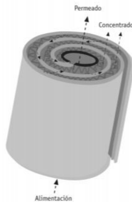
Ilustración 12 Membrana enrollada en espiral (modelo de CITME, 2006)
