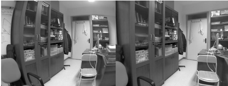
Figura 28. Eliminación de distorsión radial. Fuente: [ https://github.com/bbenligiray/lens-distortion-rectification ]
