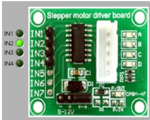
Figura 90. Indicadores y driver en el panel frontal mientras se ejecuta el programa. Fuente: Elaboración propia.
