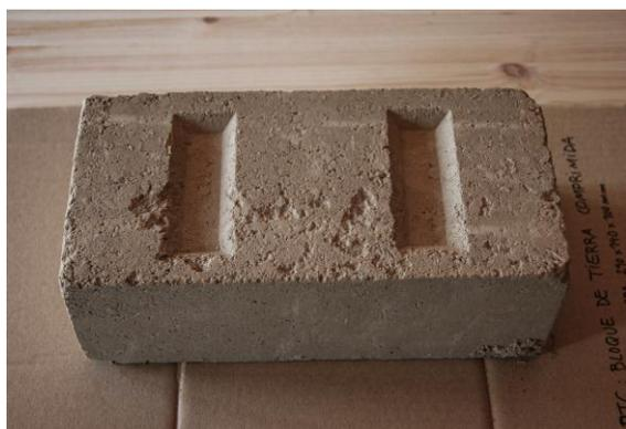
*Ilustración 3: Bloque de tierra compactada*
