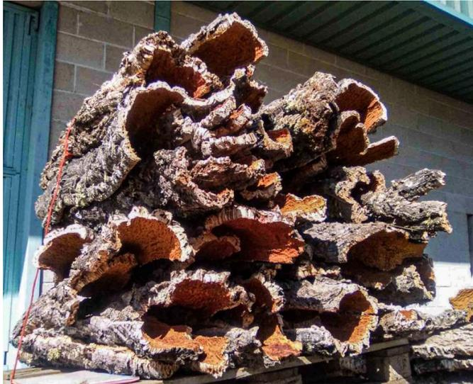
*Ilustración 38: Fardos de corcho bornizo sin procesar, apilados antes de ser convertidos en paneles.*
