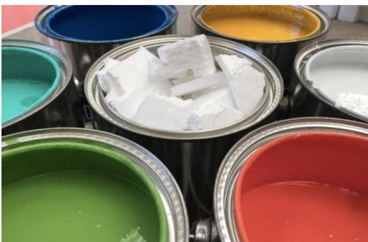
Otro ejemplo de material reciclado puede ser el EPS o poliestireno expandido. Este material es utilizado comúnmente para el control acústico y térmico de los edificios, pero hay empresas que lo están empezando a utilizar como base para las pinturas.
