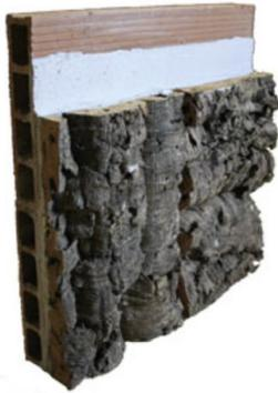
El aplacado de corcho consiste en piezas de 20x30 cm fijadas mediante un mortero directamente sobre una pared de bloques de hormigón o ladrillo. Aunque su función principal sea la de revestir también aporta un ligero aislamiento acústico y térmico. Adecuado para colocarlo tanto en interior como en exterior.
