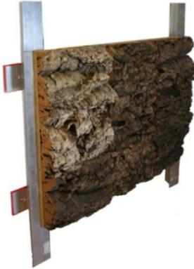
El sistema de paneles de corcho consiste en piezas de 20x30cm fijadas mediante adhesivo a un tablero OSB para dotar de cierta rigidez al panel. El panel se ancla a la sub estructura, que consta de perfiles en vertical "T" de aluminio que se fijan a unas ménsulas que se atornillan al soporte.
