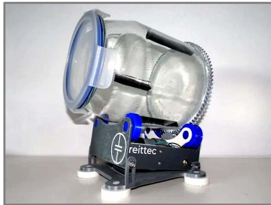
Ilustración 47 – Postprocesado por vibración con abrasivo
