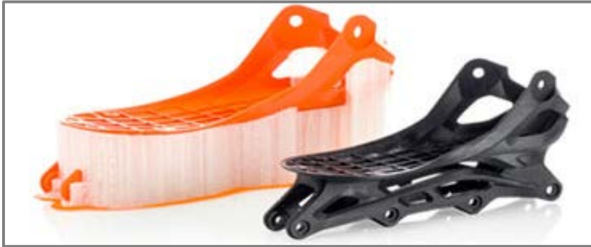
Ilustración 36 – Ejemplo PVA como soporte
