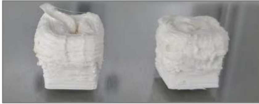
Ilustración 84 – Fallo por flujo de extrusión alto
