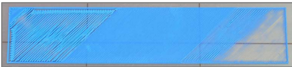
Ilustración 55 – Altura cama extrusor: alta, correcta y baja.
