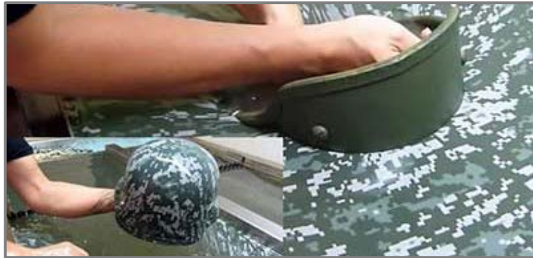
Ilustración 51 – Postprocesado por hidroimpresión
