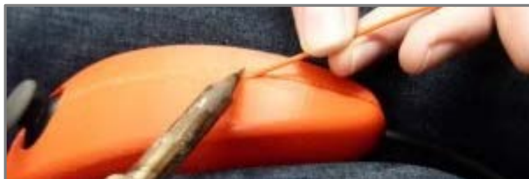
Ilustración 52 – Postprocesado unión por soldadura
