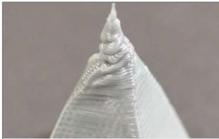
Ilustración 65 – Efectos del Sobrecalentamiento u Overheating
