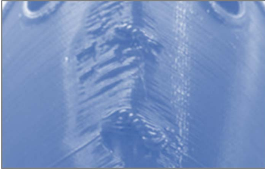
Ilustración 64 – Efectos del Sobrecalentamiento u Overheating
