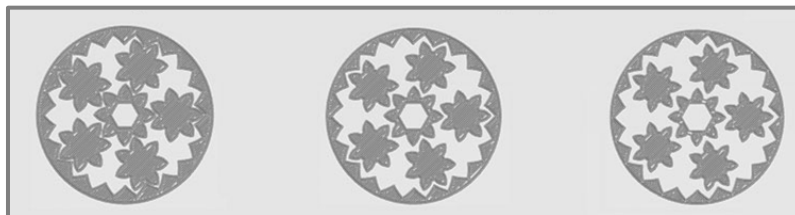
Ilustración 99 – Expansión horizontal: excesiva, correcta, insuficiente
