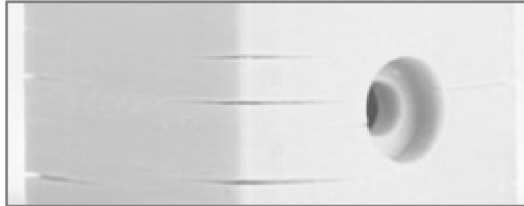
Ilustración 60 – Cracking o delaminación
