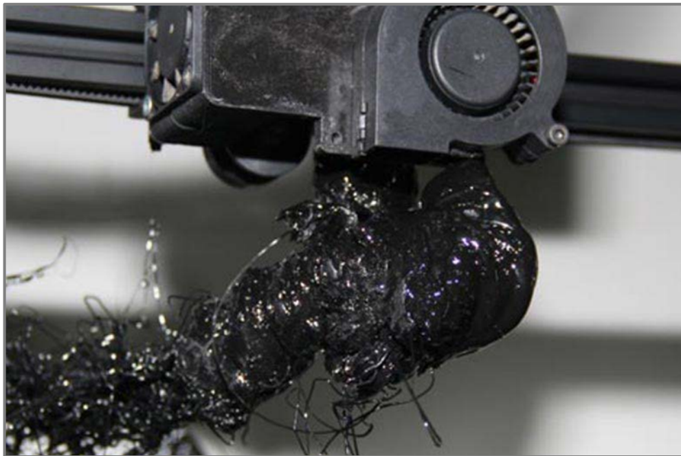
Ilustración 53 – Atasco grave del extrusor.
