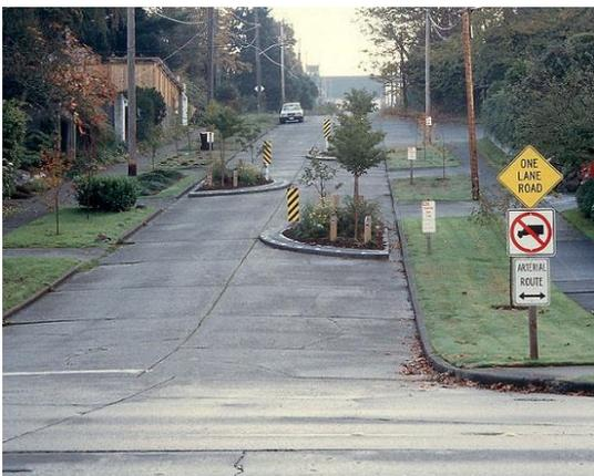
FIGURA 13. Desvío del eje mediante "chicanes"
