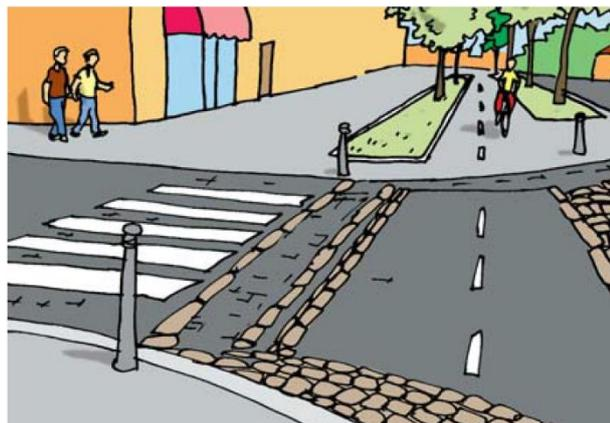
FIGURA 28. Cambio de pavimento en un cruce
