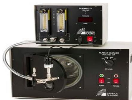
**Fig. 21.** Cámara de plasma y mezclador de flujo Harrick Plasma (61).
