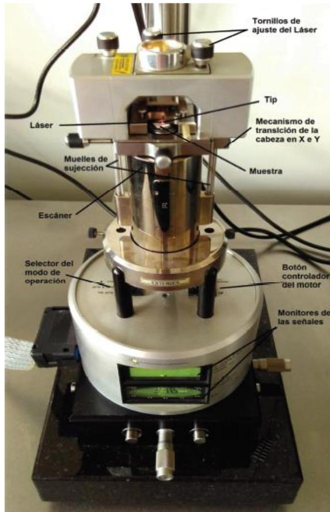
**Fig. 16.** NanoScope MultiMode<sup>TM</sup> IIIa
