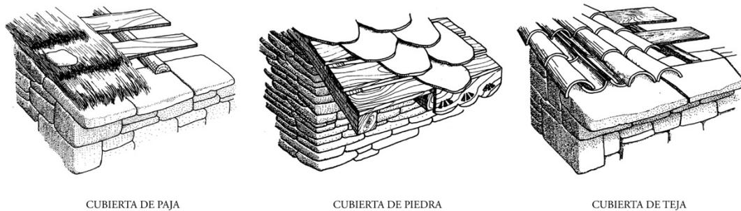
Figura 18: Soluciones de cubierta según el material empleado
