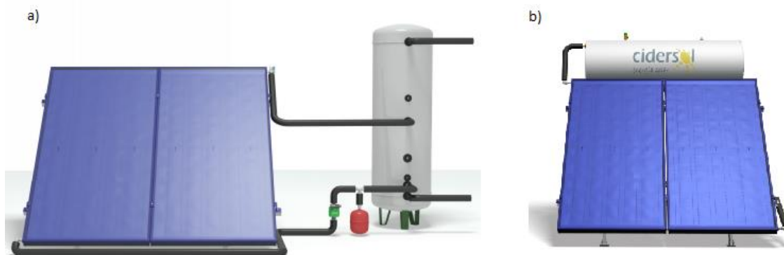
Figura 3.5 a) Depósito acumulador posición vertical, b) Depósito acumulador posición horizontal (6)
